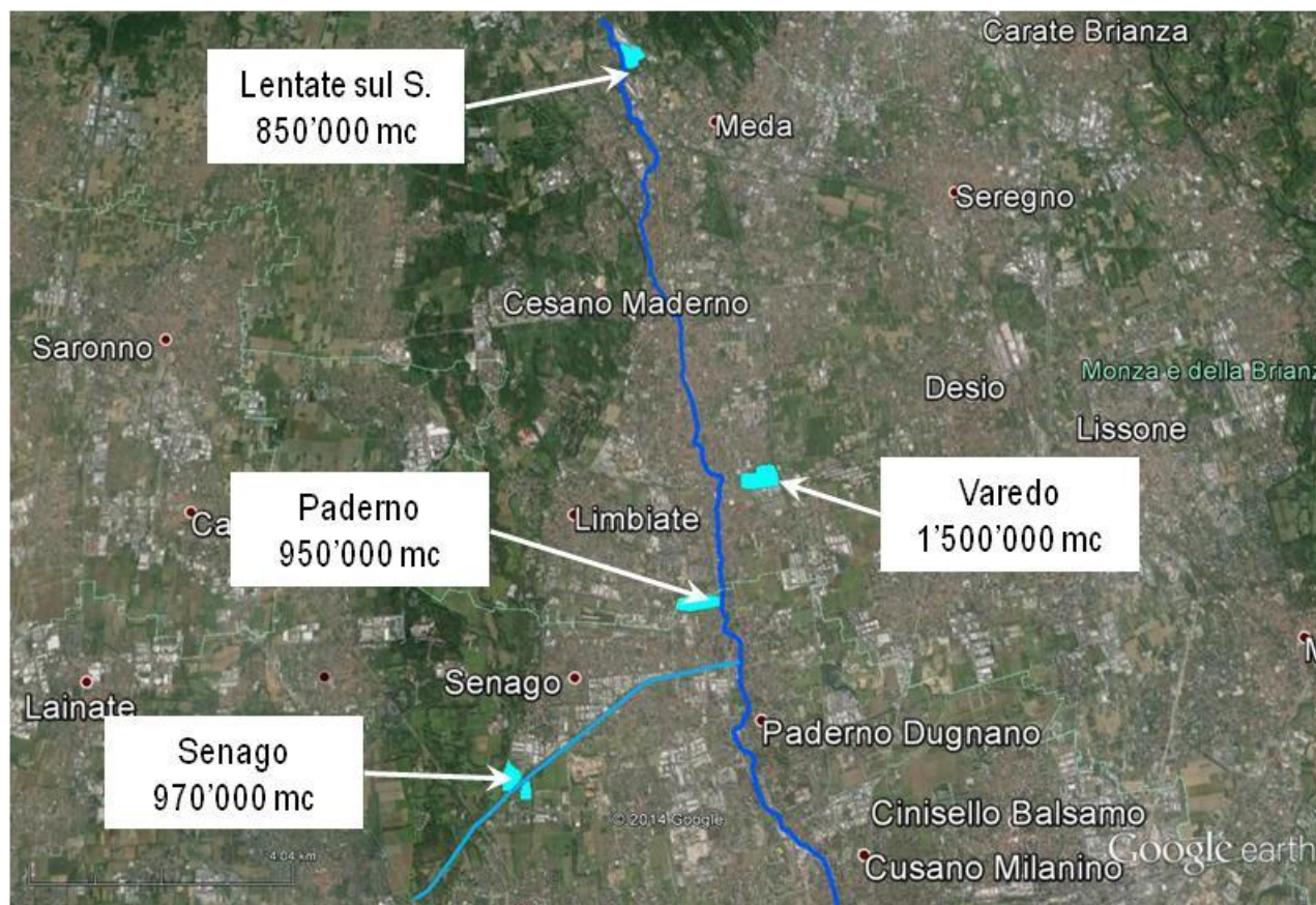
Figura 10 – Invasi di laminazione in scavo da Lentate sul Seveso al CSNO (come da Studio-AIPo-2011 ).
